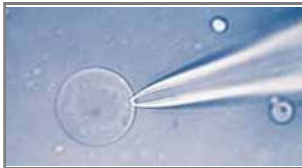
Figura III.1. Formación de un sello de alta resistencia. Se muestran una micropipeta de vidrio y una célula en el transcurso de la formación de un sello de alta resistencia o “gigasello”.
