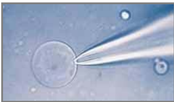
Figura III.1. Formación de un sello de alta resistencia. Se muestran una micropipeta de vidrio y una célula CHO en el transcurso de la formación de un sello de alta resistencia o “gigasello”.
